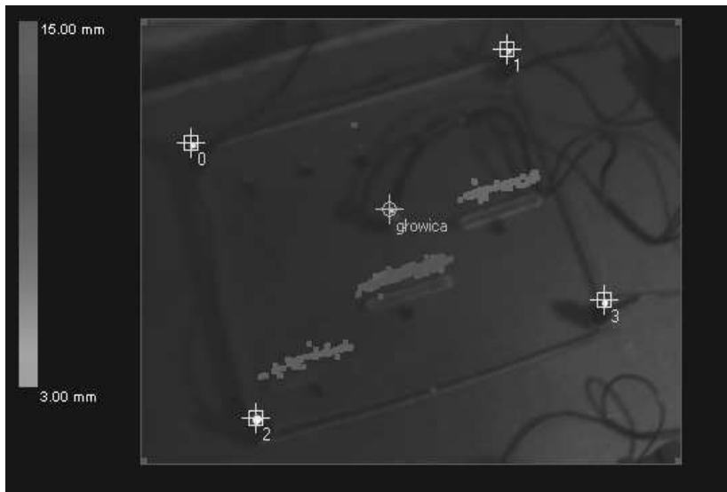
Rysunek 6. Obraz barwny z naniesioną mapą wad oraz wykrytą głowicą i markerami
