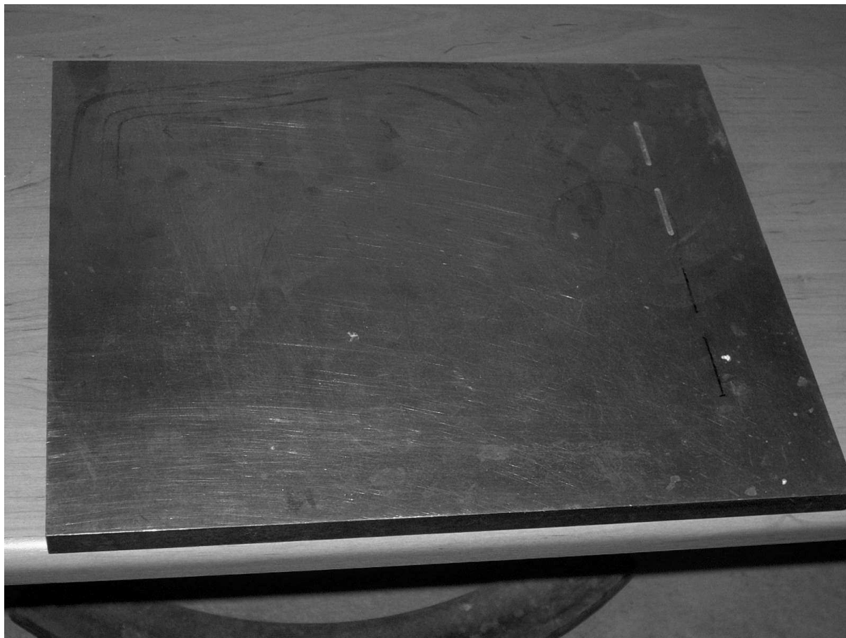
Rys 6. Blacha stalowa o grubości 15 mm z dwoma nafrezowanymi nacięciami
