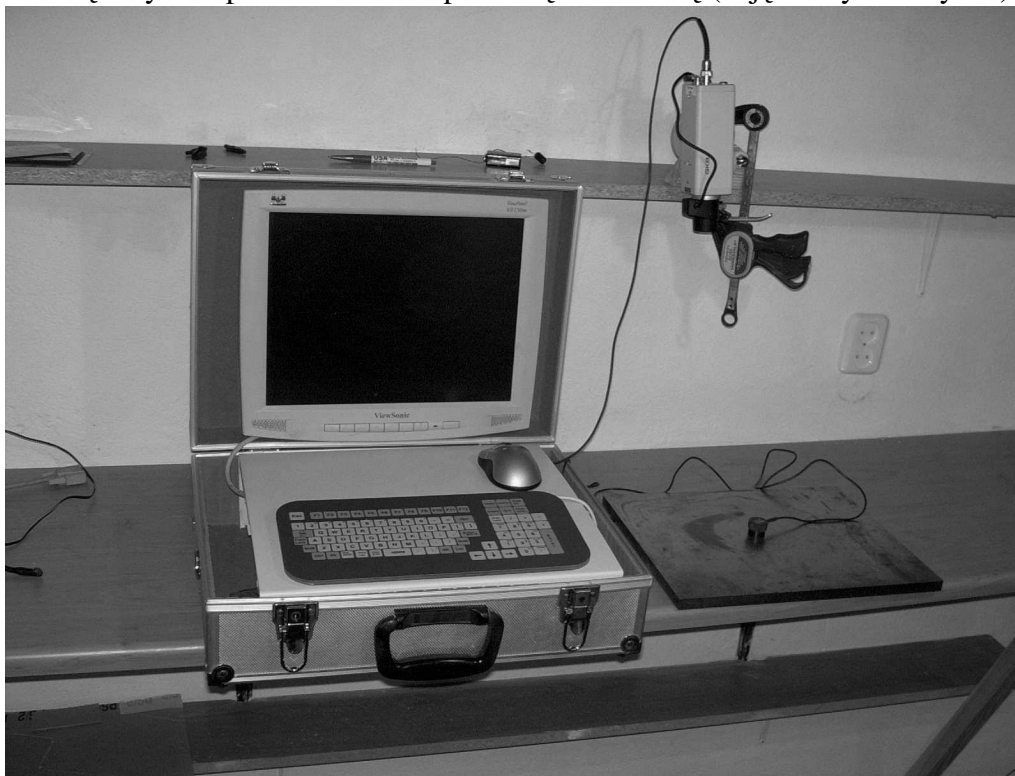
Rys 1. Zdjęcie defektoskopu VUD 001 (prototyp)
